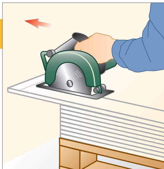
Zagen van de Rigidur gipsvezelplaten
